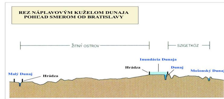
Obr. 2.4 Rez náplavovým kuželom Dunaja Fig. 2.4 Cross-section through the Danube alluvial fan
