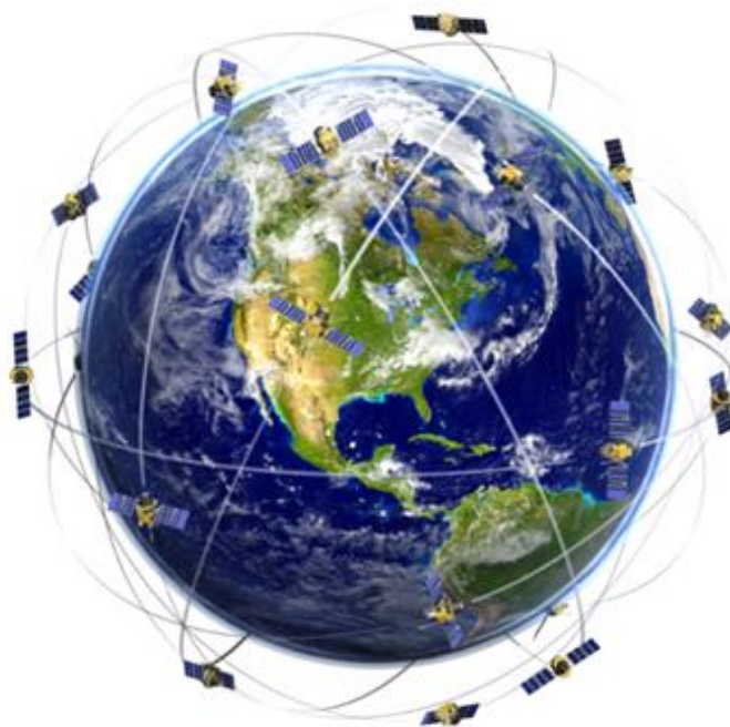
Obr. 2.12: Kozmický segment GPS a konštelácia satelitov.
