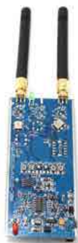
Obr. 2.30: Profesionálny testovací modul generátora signálov GPS s anténami
