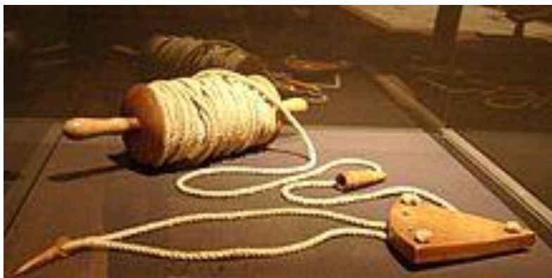
Obr. 1.8: Lano na meranie rýchlosti s naviazanou doskou (log).
