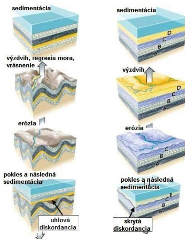
Obr. 36. Schéma vzniku uhlovej diskordancie (vľavo) a skrytej diskordancie (vpravo). Písmenami sú označené vrstvy sedimentárných hornín podľa veku: A – najstaršia vrstva až E – najmladšia vrstva vzniknutá po hiáte a erózii vrstvy D (www_26, upravené).
