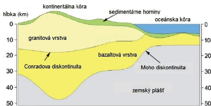
Obr. 5. Schematický prierez stavbou zemskej kôry znázorňujúci prítomnosť granitovej vrstvy v kontinentálnej kôre, ktorá je od bazaltovej vrstvy oddelená Conradovou diskontinuitou (www_5, upravené).
