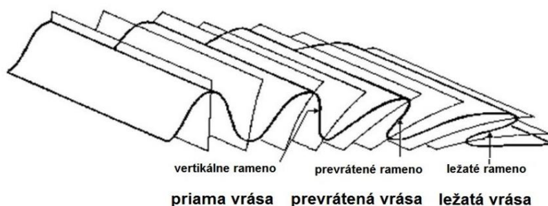
Obr. 38. Schéma klasifikácie vrás podľa úklonu osovej roviny vrás (www_28, upravené).
