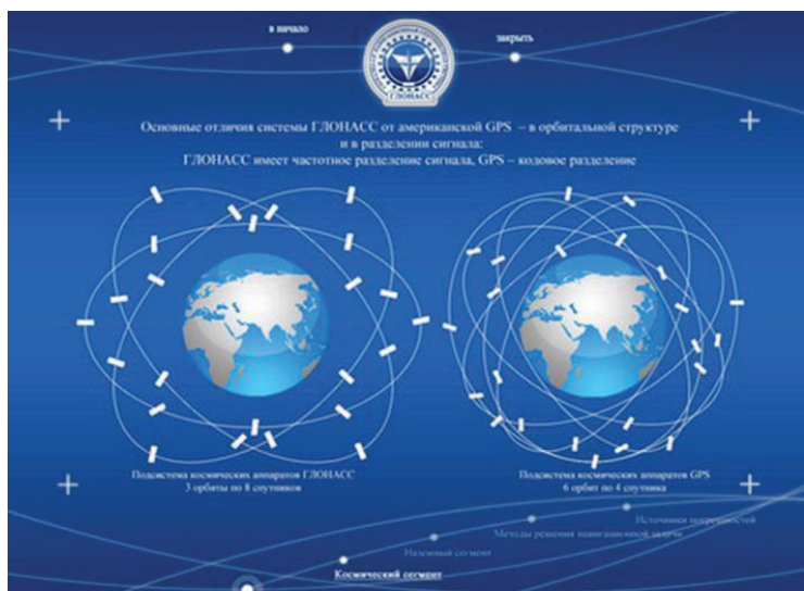
Obr. 2.40: Odlišnosť v konštelácii satelitov GLONASS (vľavo) a GPS (vpravo). (Zdroj: Bisht, 2016).
