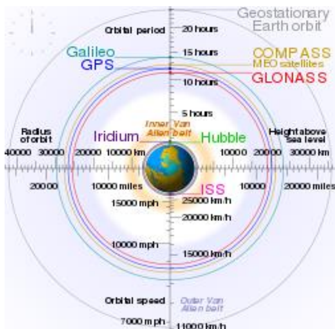
Obr. 2.6: Porovnanie geostacionárnej obežnej dráhy, obežných dráh GPS, GLONASS a Galileo a strednej obežnej dráhy (Compass). (Zdroj: Gini, 2014).
