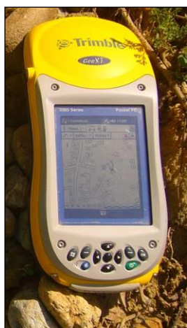
Obr. 2.4: Rôzne typy GNSS prijímačov: ručné PDA GIS prijímače od Trimble (a) Juno SB s menej presnou a (b) GeoXT s presnejšou anténou, (c) zostava dvoch presných geodetických GNSS prijímačov TOPCON Hyper II pre diferenciálne určovanie polohy.
