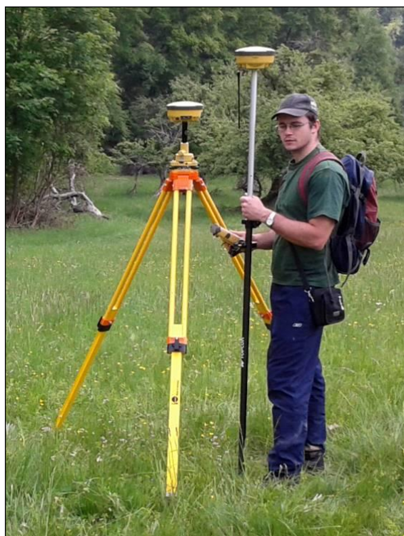
Obr. 2.4: Rôzne typy GNSS prijímačov: ručné PDA GIS prijímače od Trimble (a) Juno SB s menej presnou a (b) GeoXT s presnejšou anténou, (c) zostava dvoch presných geodetických GNSS prijímačov TOPCON Hyper II pre diferenciálne určovanie polohy.
