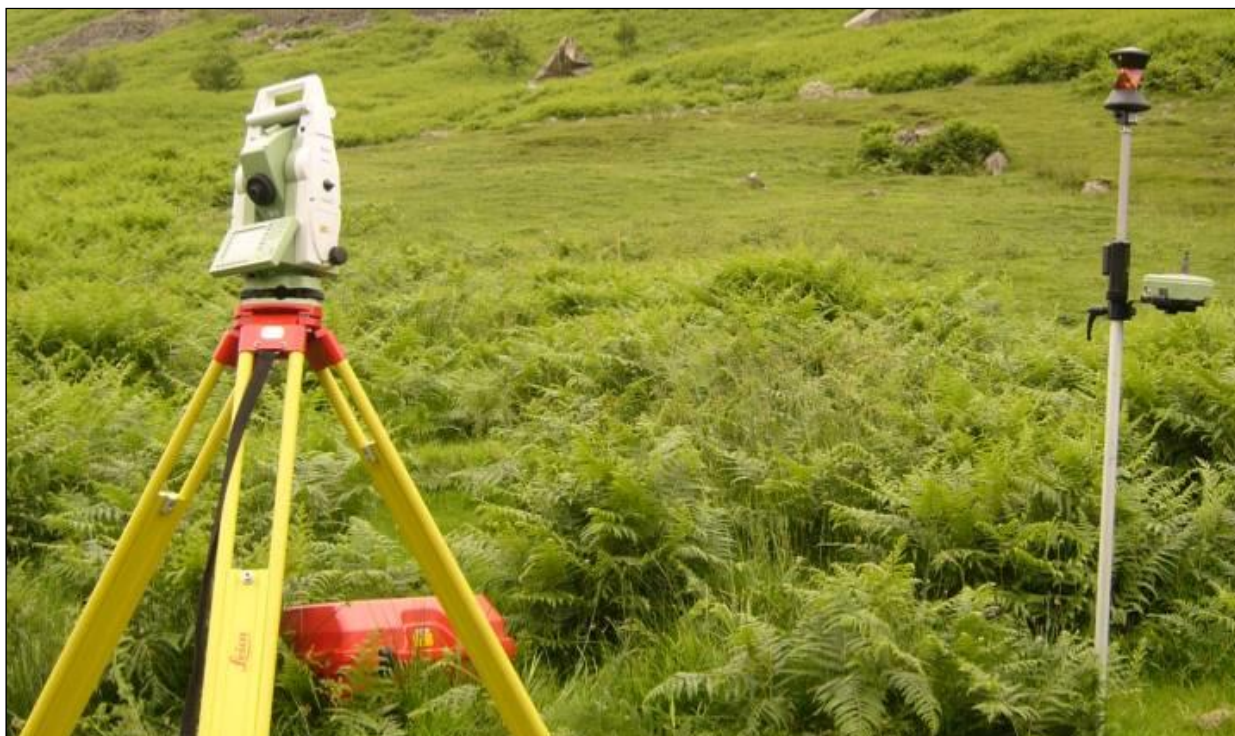
Obr. 2.1: Totálna stanica TPS 1200+ od firmy Leica Geosystems s hranolom na výtyčke s diaľkovým ovládaním stanice pre jednoosobový režim merania.
