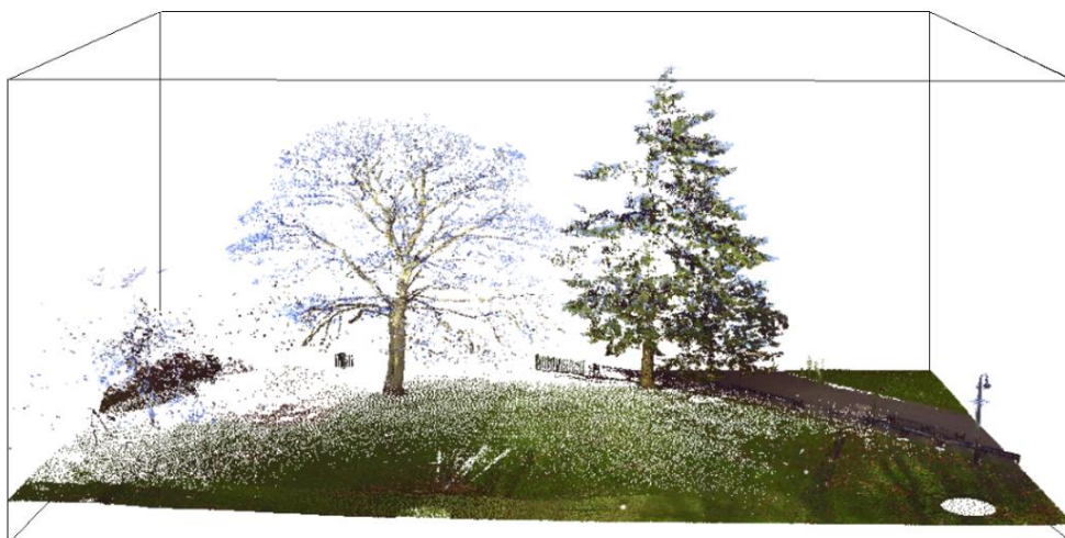
Obr. 2.22: Mračno bodov získané pozemným laserovým skenovaním v Botanickej záhrade v Belfaste obsahujúce okolo 2 miliónov bodov zafarbených na základe farebnej fotografie. Zdroj: Ústav geografie PF UPJŠ v Košiciach, spracoval: Andrew Bell.
