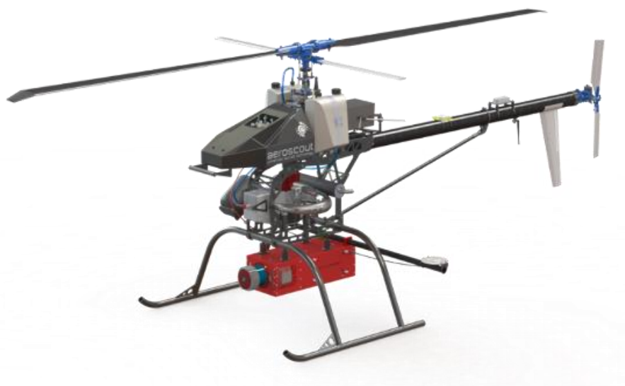
Obr. 8.20: Bezpilotná helikoptéra Scout B1-100 s integrovaným laserovým skenerom VUX-1 od firmy Riegl. Zdroj: Aeroscout GmbH
