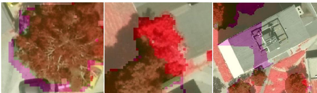
Obr. 51 Oblasť okolo stromu, klasifikovaná ako strom (vľavo), stromy nad strechou, ktoré LasTools neklasifikoval ako stromy (v strede), zlé klasifikované nepriavidelné strechy (vpravo).
