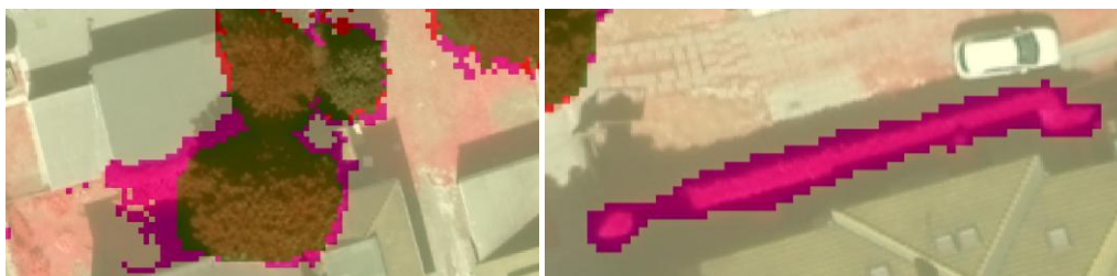
Obr. 55 Nesprávne identifikovaná plocha kvôli nesprávnej veľkosti segmentov (vľavo), živý plot klasifikovaný ako strom (vpravo).
