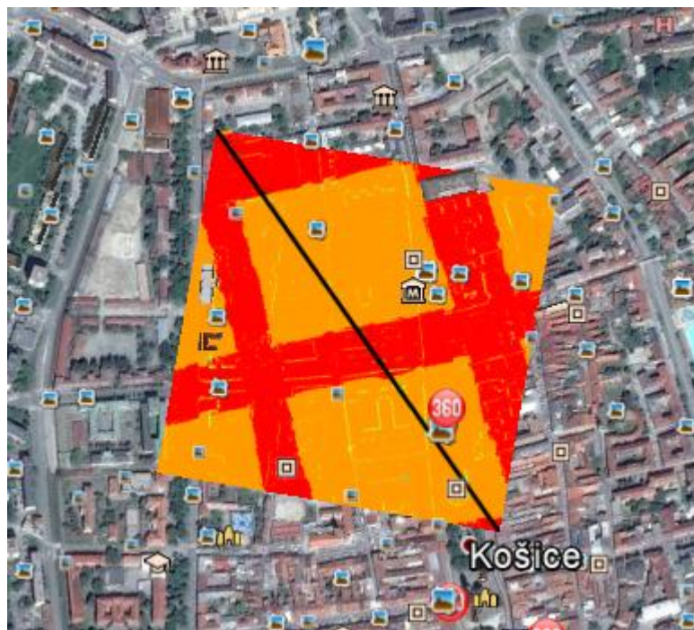
Obr. 26 KML výstup zobrazený v Google Earth, vytvorený v lasoverlap , poukazujúci na prekryt v dátach.
