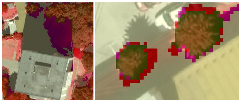
Obr. 59 Klasifikácia ovplyvnená tienením budov pri manuálnej klasifikácii (vľavo), chybné klasifikované územie, spôsobené ľudskou chybou (vpravo).
