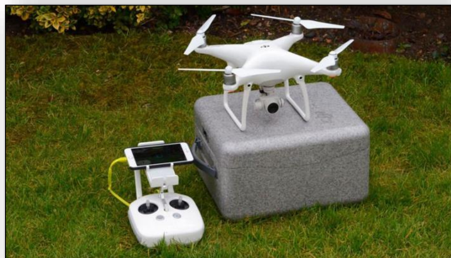
DJI Phantom 4 pre fotogrametrický prieskum a 4k video (1,4 kg)
