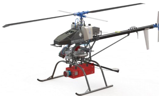
Obr. 8.26: Bezpilotná helikoptéra Scout B1-100 s integrovaným laserovým skenerom VUX-1 od firmy Riegl. Zdroj: Aeroscout GmbH
