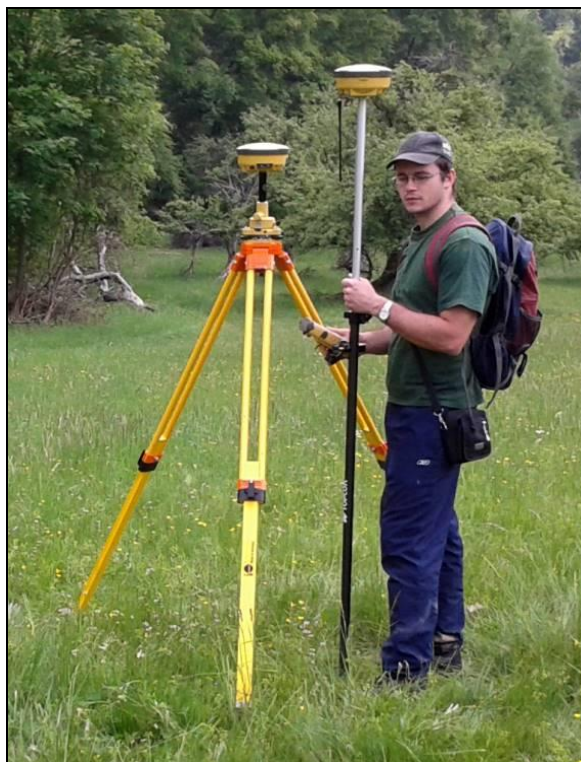
Obr. 4.4: Rôzne typy GNSS prijímačov: ručné PDA GIS prijímače od Trimble (a) Juno SB s menej presnou a (b) GeoXT s presnejšou anténou, (c) zostava dvoch presných geodetických GNSS prijímačov TOPCON Hyper II pre diferenciálne určovanie polohy.
