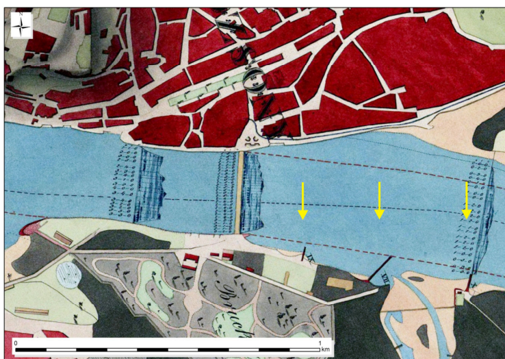
Obr. 13. Časť úseku Dunaja pri Bratislave s priečnymi profilmi na georeferencovanom výreze mapy z roku 1845 (č. 21 v Zozname). Doplnené žlté šípky zvyrazňujú výhony č. IX, VII a X na pravom brehu Dunaja poniže Auparku a v hornom ústí Chorvátskeho ramena, vybudované v rokoch 1832 až 1834. Karmínová prerušovaná čiara označuje projektované brehovú líniu nového koryta, modrá prúdnicu resp. plavebnú dráhu rieky.
