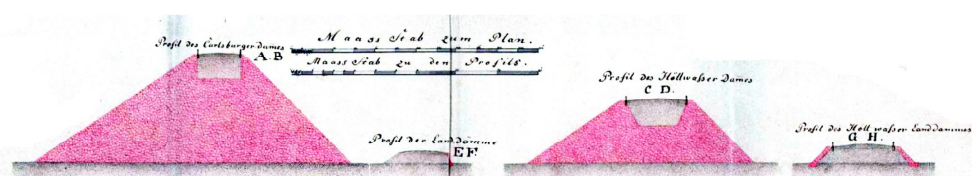
Obr. 6. Porovnanie priečných profilov cestných hrádzi a prehrádzok ramien; Zľava doprava: prehrádzka horného ústia Chorvátskeho ramena (A B), cestná hrádza na úseku Auparku (E F), prehrádzka ramena Hellwasser (C D) a Viedenská cestná hrádza pri Petržalke (G H). Detail z mapy na obr. 1
